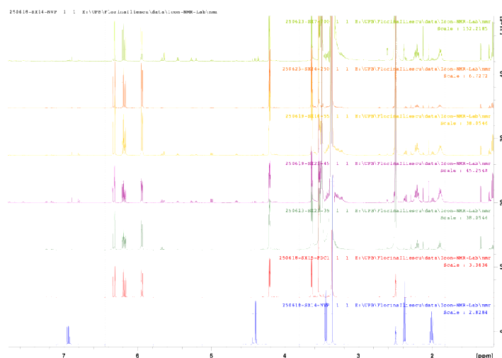
Figura 18. Caracterizare structurală prin NMR a microacelor printate 3D pe bază de PEGDA
