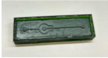
Figura 8. Matrița pentru realizarea cipului din PDMS
